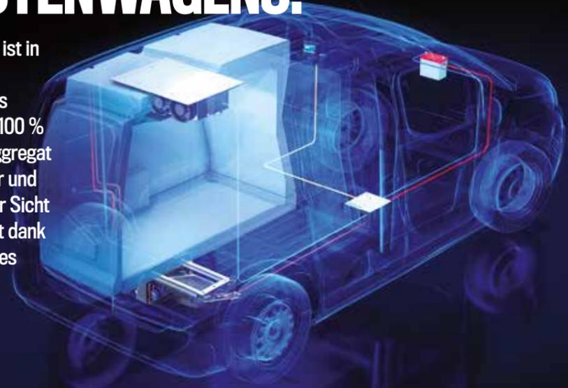
**E**ntwickelt wurde das Kühlaggregat e-CoolJet 106 für Kastenwagen mit geregelter Temperatur der ATP-Klasse A (Pluskühlbereich) bis 5 m<sup>3</sup>.
