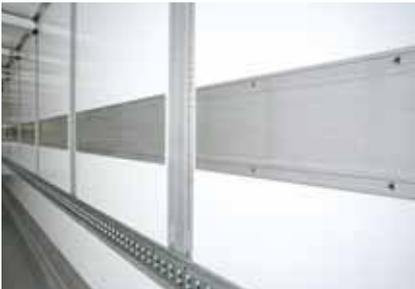
**100 % vertikal-eingelassene Duplex-Schienen:** Das Duplex-System besteht aus 12 abriebfesten, hochleistungsfähigen Aluminiumschienen, die im Abstand von 1208 mm und ohne Winkel an den Seiten montiert sind. Sie gewährleisten eine stärkere Isolierungsqualität, ohne die Nutzlast und die Beladungsvorgänge zu beeinträchtigen.
