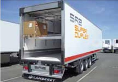
**Hebetür:** Der isolierende Türrahmen mit manueller oder elektrischer leiser Öffnung (PIEK-Zertifizierung 54dB) erleichtert den Verteilerverkehr. Die Tür aus Inox ist vollständig verschraubt und verfügt über einen umlaufenden Schutz (Schwelle, vertikale Träger oben und unten).
