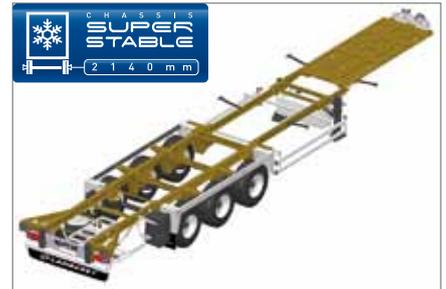
**Fahrgestellsystem „SuperStabil“:** Eine neuartige Kombination, mit der der Schwerpunkt durch die kürzeren, nur 180 mm hohen H-Längsträger aus THLE-Stahl gemeistert wird, und einem breiteren Fahrgestell, das das Absenken in den Kurven reduziert und damit die kritische Geschwindigkeit bei Kurvenfahrten verringert.
