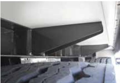
**Laterale Stabilisatoren:** Das Gewicht der Duplex-Beladung wird in die Seitenwände abgeleitet. Diese Kräfte werden durch die integrierten, lateralen Stützelemente zur Mitte des superstabilen Fahrgestells hin abgeleitet. Die vertikalen Kräfte werden besser ausgeglichen und die Tragfähigkeit des Bodens wird verbessert, wovon die Stabilität profitiert.
