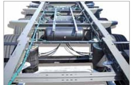
**Verbreiterter Achsstand von 2140 mm:** Das breitere Fahrwerk ist konkurrenzlos. Der Abstand der Längsträger des zentralen Moduls wurde um 100 mm auf 1400 mm erhöht, damit wird ein Achsstand von 2140 mm erreicht, was dem strengsten Standard, der für Tankwagen ausgelegt ist, entspricht. Das Fahrgestell „Super stabil“ erhöht die Überrollstabilität um 15 %; Verbesserung gemäß ECE Nr. 111, Anhang 4.
