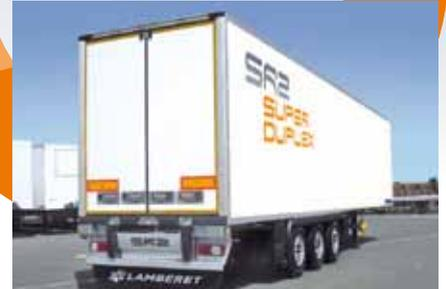
**Green Liner Aluminium-Rahmen 4 Verschlüsse:** Der Rahmen ist leicht und langlebig mit doppeltem, eingelassenen Gestänge, das speziell so positioniert ist, damit das Be- und Entladen gemeistert und das Öffnen erleichtert wird. In der unteren Traverse aus Aluminium mit Aufmaß sind eine doppelte Scheuerleiste und 4 durchgehende Puffer integriert.
