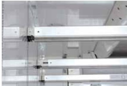
**22 vertikal verstellbare und bewegliche Duplex-Träger, im Abstand von 25 mm:** Sie haben eine Kapazität von jeweils 1 Tonne, sodass 33 Paletten à 800 x 1200 mm beladen werden können. Für Paletten mit den Maßen 800 x 600 mm lassen sich Zwischenschienen montieren.
