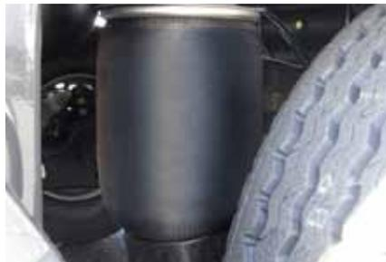
**Verbesserte, 360 mm starke Dämpfungskissen:** Mit 44 % mehr Auflagefläche wird die Ladung besser aufgenommen, die Federung senkt sich weniger und bietet mehr Widerstand, die Schwerpunktverlagerung wird verringert. Ein doppelter, pneumatischer Kreislauf versorgt jede Seite der Federung unabhängig voneinander, um ein Schlingern in den Kurven abzdämpfen.
