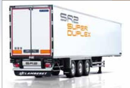
**Heavy Duty Heckrahmen aus Inox:** Entwickelt, um die Widerstandsfähigkeit des beladenen Koffers zu maximieren. Die obere Traverse aus Inox und die vertikalen H-Träger werden vollständig mit 12mm starken THLE-Stahlwinkeln und Eckblechen ausgekleidet, die Lasten aufnehmen, ohne sie in den Ecken zu konzentrieren.
