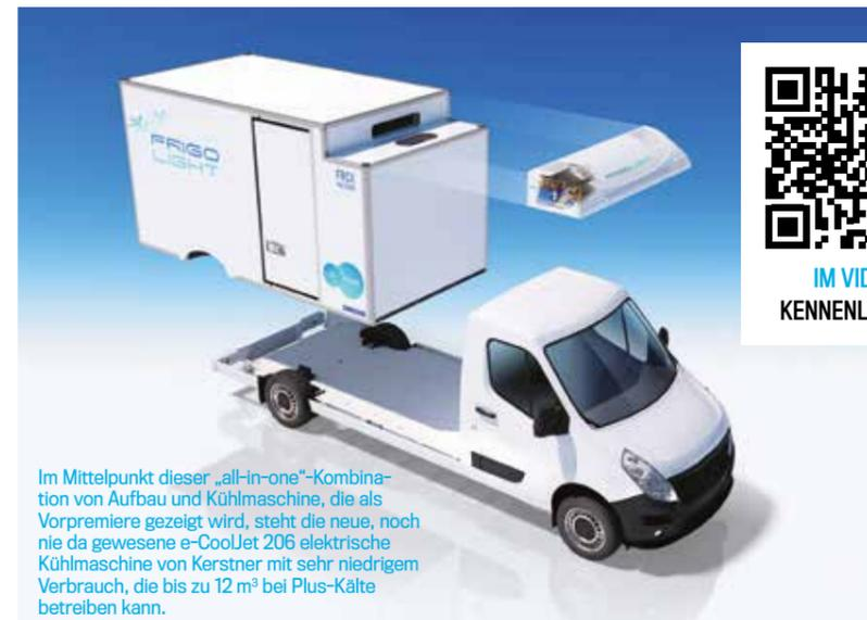
Im Mittelpunkt dieser „all-in-one“-Kombination von Aufbau und Kühlmaschine, die als Vorpriemiere gezeigt wird, steht die neue, noch nie da gewesene e-CoolJet 206 elektrische Kühlmaschine von Kerstner mit sehr niedrigem Verbrauch, die bis zu 12 m³ bei Plus-Kälte betreiben kann.
