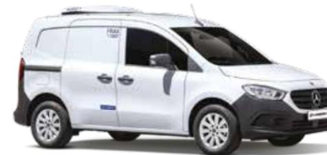
Völlig neu ist der Citan die ideale Basis für einen Kühlkastenwagen, der in der Lage ist, unter besten Bedingungen fast 2m3 transportieren kann. Die Kühlzelle bietet von Anfang an eine seitliche Schiebetür, während sie über eine verstärkte ATP-Zulassung in isothermer Qualität verfügt, um die Kühlkette aufrecht zu erhalten und den Energieverbrauch zu optimieren. Erhältlich in den Längen L1 und L2.. ■
