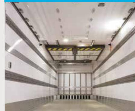
Das pneumatisch betätigte Rolltor Distri+ ermöglicht vollautomatisches Verschießen und Öffnen: Kein Abmühen mit den Griffen mehr!
