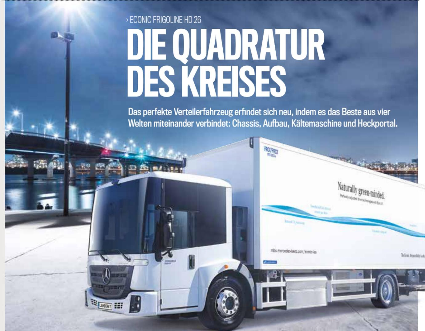
Der Mercedes Econic bietet dem Fahrer großen Komfort. Das Niederflur-Fahrerhaus und die pneumatische Falttür auf der Beifahrerseite erleichtern das sichere Ein- und Aussteigen. Das Streben nach optimaler Ergonomie zeigt sich auch im Aufbau von Lamberet, der mit dem pneumatisch betätigten, automatisch öffnenden Rolltor für das Heckportal Distri+ und mit der neuen Multi-Temperatur-Trennwand Ergowall ausgestattet ist.
