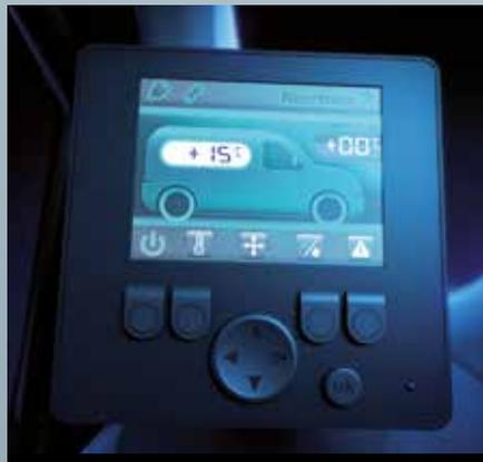
Steuereinheit des Kühlaggregats mit 8"-Farbbildschirm
