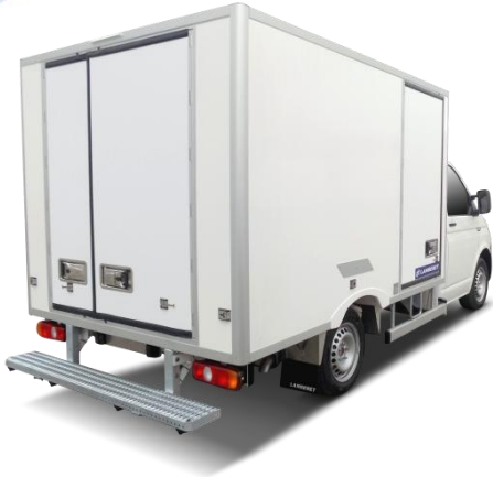
Abgesenkte Kühlzelle vom Typ Kühlkoffer, optional mit Radkästen
