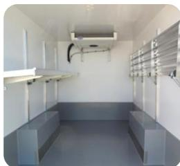
Dieser Aufbau ist für den temperaturgeführten Transport bestimmt und erfüllt die geltenden ATP-Richtlinien.
