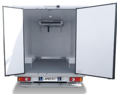
Diese Karosserie dient dem Transport unter geregelter Temperatur in Übereinstimmung mit den geltenden ATP-Richtlinien.
