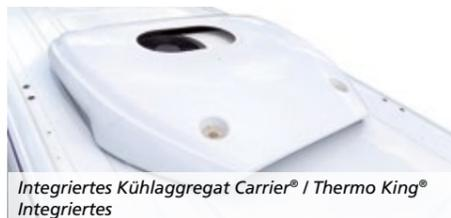
Integriertes Kühlaggregat Carrier® / Thermo King®
