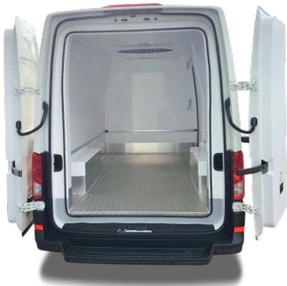
Diese Karosserie dient dem Transport unter geregelter Temperatur in Übereinstimmung mit den geltenden ATP-Richtlinien. **BASISFAHRZEUG FÜR DEN UMBAU**
