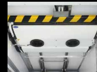
**División transversal móvil sobre 2 guías correderas:** fácil de usar gracias a su trampilla de descompresión y apertura y cierre asistidos mediante compás. Junta estancia multilabio de silicona compatible con temperaturas negativas.
