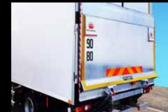
**Compuerta elevadora:** la parte trasera del bastidor se puede equipar con diferentes configuraciones de compuerta para facilitar las maniobras, compuerta abatible o semicpuerta, disponibles para varias cargas y dimensiones.
