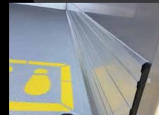
**Zócalo específico de aluminio** de una sola pieza, encolado y reforzado por 6 nervaduras de 5 mm con pliegue encastrado, encolado y atornillado a la plataforma. Altura de 300 mm, fijación reforzada al inicio del marco con juntas de rotura de puente térmico.
