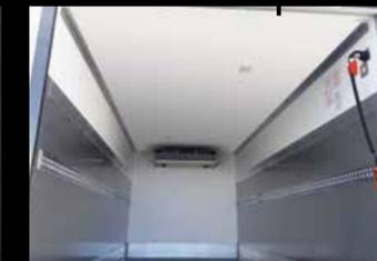
**Forro parcial de Interinox:** actúa como un blindaje y se superpone al revestimiento de poliéster. El acero inoxidable ralentiza el desgaste por abrasión y refuerza las caras laterales expuestas a las rasgadas y punzonamientos de los huesos de las piezas de carne.
