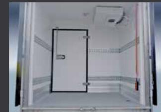
**División transversal fija:** dependiendo de las necesidades, la caja se puede equipar con una división transversal fija con una puerta de acceso al compartimento delantero.
