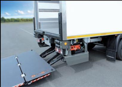
**Compuerta elevadora silenciosa (PIEK- 56 dB).** El chasis del SuperCity puede albergar una compuerta elevable, un accesorio indispensable para los trabajos de distribución en el ámbito urbano. La compuerta está protegida frente a los golpes mediante unas canaletas laterales. Puede disponer del certificado acústico. Foto: Compuerta elevable DHOLLANDIA DHSM2000 PIEK.
