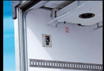
**Sistema de subida y bajada 100% neumático y autónomo** mediante control interno. Exclusiva LAMBERET - HALDEX, acciona a partir de una reserva adicional de aire (60 litros) la válvula de subida y de bajada. Funciona sin necesidad de conexión y sin alimentación eléctrica. Su mando de control interno permite nivelar el SR2 SuperCity.
