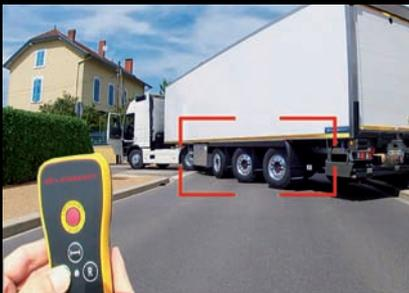
**Control de los ejes direccionales.** El control por mando a distancia permite posicionar previamente los ejes direccionales, desde el asiento del conductor, en el ángulo deseado, independientemente del ángulo de la cabeza tractora. Una gran ventaja para salir indemne en aquellas situaciones y maniobras de máxima precisión.
