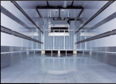
**Plataforma de aluminio antideslizante flotante, con certificado PIEK (55 dB). Patentada.** Combina resistencia al desgaste, aislamiento acústico e impermeabilidad. Sus perfiles cuentan con un ranurado antideslizante longitudinal. Una junta periférica asegura la ruptura del puente vibratorio. Los zócalos del HD(1), los mayores del mercado (300 x 7 mm), están encolados, atornillados y remachados.
