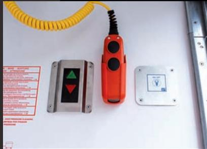
**Panel de mandos internos.** Máxima ergonomía y seguridad: la platina de mando extraplana de las luces con temporizador, el mando a distancia de la compuerta elevable y el control interno de la persiana eléctrica están agrupados en la parte superior derecha del cuadro de mandos, lejos de la zona de choque de los aparatos de mantenimiento.
