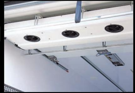
**Módulo multitemperatura silencioso (PIEK).** El chasis del SuperCity permite albergar los sistemas de refrigeración multitemperatura silenciosos más potentes, como el módulo CARRIER Vector City 1850 MT City. El motor del módulo, así como el sistema de evacuación se encuentran ubicados bajo el chasis, de forma que se reduzca la contaminación acústica.
