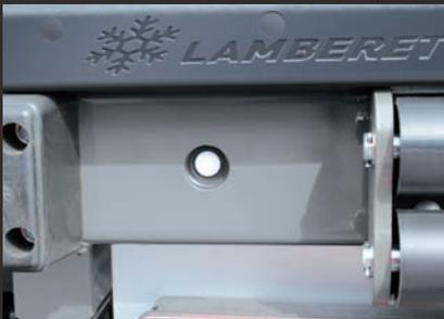
**Sistema de asistente Soft Docking TOTALMENTE integrado.** Al acercarse al muelle de carga, los dos radares integrados y protegidos en el travesaño trasero del chasis detectan la presencia y frenan automática y progresivamente el vehículo antes del impacto, evitando así cualquier daño en la carga o en el remolque. El conductor se libera así de la situación de estrés incluso en casos de poca visibilidad o de maniobras complicadas, como suele ocurrir en los entornos urbanos.
