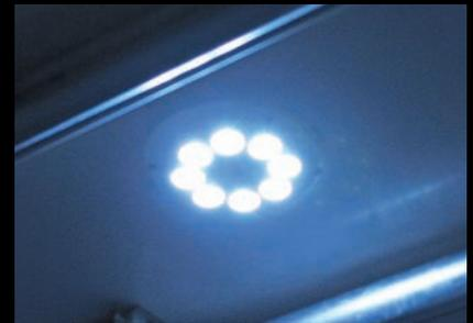
**Cuatro plafones encastrados de 8 luces LED con interruptor interior temporizado.** Entre todos proporcionan una iluminación excepcional con un bajo consumo eléctrico y gran durabilidad. Encastrados, al igual que los interruptores, no afectan a las labores de carga y descarga ni a los dispositivos de mantenimiento.
