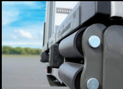
**Protección antichoque y topes de rodillos amortiguadores bitubos de acero** (patente Lamberet). Los topes de rodillos, dotados de un tubo de acero externo y de caucho alveolar interno montados sobre un eje de acero, absorben los golpes. Los esfuerzos residuales se disipan mediante el brazo de refuerzo de gran inercia del chasis.
