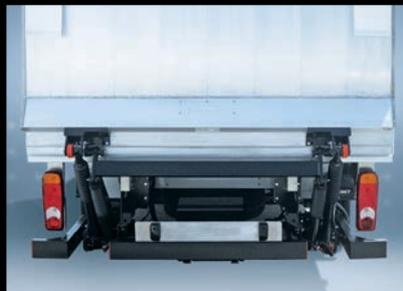
**Compuerta elevadora :** La parte trasera del chasis se puede equipar con diferentes configuraciones para la compuerta y, de este modo, agilizar las maniobras de carga y descarga: compuerta abatible o semicompuerta, disponibles en diferentes cargas y dimensiones.
