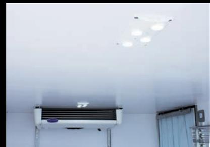
**Iluminación LED :** Un panel de LED (o dos, si la longitud interior es superior a los 3,90 m) asegura una perfecta iluminación, un reducido consumo eléctrico y una gran durabilidad. Es extraplano, al igual que el interruptor, para que no se enganchen en él la carga ni las herramientas de mantenimiento.
