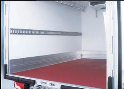
**New Frigoline Beef :** (Imagen: New Frigoline Pro Beef) especialmente concebido para el transporte de carne, esta versión está equipada con una estructura reforzada para poder fijar las barras adaptadas a su sector de actividad: barras de ganchos, barras deslizantes, barras de doble raíl o barras de tubo, con o sin ganchos.
