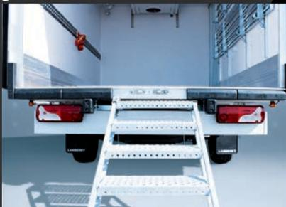
**Acceso trasero :** El doble estribo, plegable o basculante, se adapta a las labores de distribución gracias al pequeño espacio que ocupa. La escalera trasera, de 4 o 5 peldaños, facilita las labores de carga y descarga, especialmente para el transporte de carne. Si se añade un estribo, se puede agilizar aún más el acceso.
