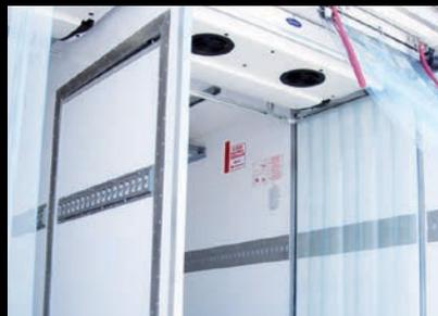
**Separaciones :** Permiten crear varios compartimentos y transportar alimentos frescos y congelados al mismo tiempo. Pueden ser fijas, longitudinales o transversales, con o sin puerta, o transversales de corredera y plegables mediante brazo articulado de gas.
