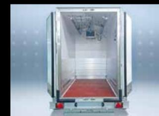
Colgadores para carne (opcionales): En su versión portacarne, los remolques a partir de 1300 kg disponen de inserciones en la estructura para fijar el sistema que mejor se adapte a su sector de actividad: barras con ganchos fijos o desmontables, colgadores deslizantes, sistemas de doble rail, de tubo o mixtos. Como complemento, la plataforma puede ser antideslizante de grano grueso de color rojo.
