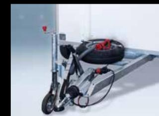
Herrajes del chasis (de serie): Todos los remolques disponen de unos herrajes completos: rueda jockey para facilitar las maniobras; 2 caballetes estabilizadores en la parte trasera y freno para su uso estático o para el aparcamiento; rueda de repuesto y manivela; conector de remolque de 13 clavijas con adaptador de 7 clavijas desmontable.
