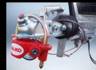
Antirrobo (opcional especial): Para mayor seguridad, este antirrobo se fija en el enganche y, de este modo, impide la tracción del remolque. La iluminación (no figura en la imagen): si la carrocería está equipada con un grupo frigorífico (proporcionado por Lamberet), dispone de un sistema de luz que ilumina la zona de carga.
