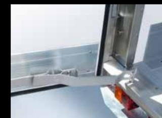
Bloqueo de puerta: Los remolques Lamberet disponen de bloques de puertas (de caucho o en forma de T, dependiendo de los modelos). Para facilitar las operaciones en las zonas estrechas de estacionamiento, disponen de bloques de 180° opcionales sobre OT2 (imagen).
