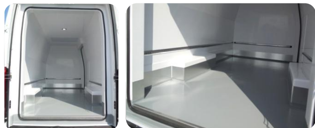
Plancher palettisable (monte simple) et protection de caisson de roue de série
