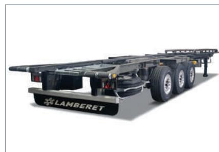
**Via assiale adattata a 2040 mm:** predisposizione completa alle limitazioni dimensionali del vagone, la via assiale del telaio è ricondotta a 2040 mm. La migliore rigidità del telaio imbullonato SR2 consente di mantenere una scarsa altezza del longherone, a vantaggio dell'abbassamento del centro di gravità, il che consente la migliore tenuta di strada del mercato.
