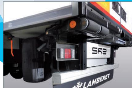
**Modulo posteriore ridimensionato:** con un ritiro di 300 mm delle apparecchiature del modulo posteriore, il posizionamento del SR2 Rail-Road sul suo vagone è facilitata, senza rischi di danneggiamenti.
