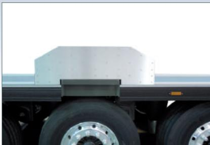
**4 zone di presa rinforzate:** profili inferiori di presa destinati alle gru a pinza e piastre laterali di protezione, per i trasbordi di SR2 Rail-Road sui vagoni in tutta sicurezza.
