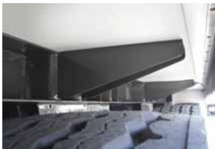
**Stabilisateurs latéraux :** Le poids du chargement duplex est renvoyé dans les faces latérales. Ces forces sont transférées vers le centre du châssis par des appuis latéraux intégrés au châssis Super Stable. L'équilibrage des forces verticales améliore la portance au sol de la charge, au bénéfice de la stabilité.
