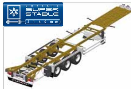
**Châssis SuperStable :** Inédit, il combine la mise sous contrôle du centre de gravité, grâce aux longerons en H en acier THLE de hauteur réduite à 180 mm, et un train roulant élargi réduisant l'affaissement en virage pour minimiser la vitesse critique de passage en courbe.
