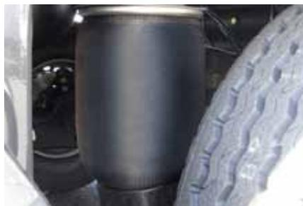
**Coussins de suspension pneumatique renforcés 360 mm :** Sur 44% de surface d'appui supplémentaire, la charge est mieux reprise, la suspension s'affaisse moins et offre plus de résistance, réduisant le déplacement du centre de gravité. Un double circuit pneumatique alimente indépendamment chaque côté de la suspension afin d'amortir le roulis en virage.
