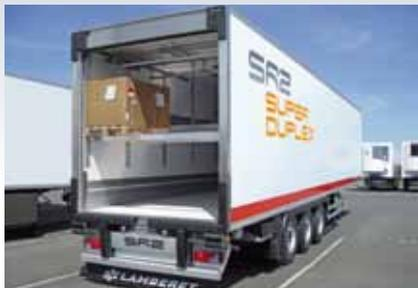
**Ouverture relevante :** Le cadre rideau isolant, à ouverture manuelle, ou électrique silencieuse (certificat PIEK 54 dB), facilite la distribution. Ultra-résistant, en inox, entièrement boulonné, il bénéficie d'une protection complète (seuil, montants verticaux bas et haut).
