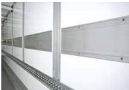
**Rails verticaux Duplex 100% encastrés :** Le système duplex comprend 12 rails alu anti-abrasion haute performance, disposés à 1208mm d'entraxe, sans retour sur les flancs. La qualité d'isolation est «Renforcée» sans compromettre la largeur utile ni les manipulations de chargement.
