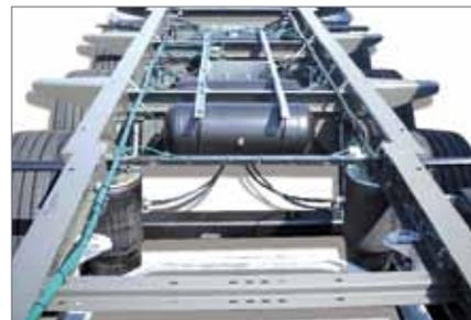
**Voie d'essieu élargie à 2140 mm :** Le train roulant élargi est inédit. L'entraxe de longerons du module central accru de 100mm à 1400mm, porte la voie d'essieu à 2140mm soit le standard de stabilité des citernes le plus exigeant. Le châssis « Super Stable » augmente le seuil de renversement de 15% : gain selon règlement CEE N° 111, annexe 4.
