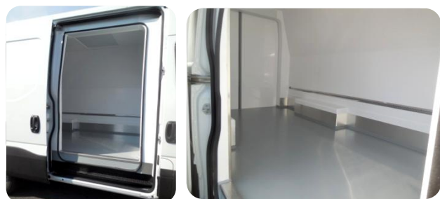
Porte latérale coulissante isolée avec double joint périphérique
