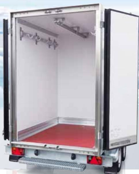
Ideato per i professionisti\* del settore alimentare e degli eventi, il rimorchio 1300 kg coniuga un volume utilizzato significativo di circa 5 m<sup>3</sup> a possibilità di adattamento ad ogni attività: versione pallettizzabile con apertura posteriore "OT", ganci per carne, scaffali appositi per la gastronomia.
