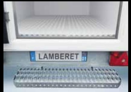
**Gradino:** Integrato nella versione 750 kg o collegato al telaio nelle versioni 1300 e 2000 kg, il gradino in acciaio fisso "1 livello" antiscivolo facilita l'accesso alla zona di carico.
