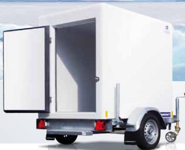
Assemblando una cassa isotermica o frigorifera con un telaio 1 asse omologato per un PTT di 500 kg, questo rimorchio risponde alla normativa per il trasporto di derrate deperibili ed è compatibile con la maggior parte dei veicoli dotati di un gancio, compresi i veicoli di tipo berlina\*.
