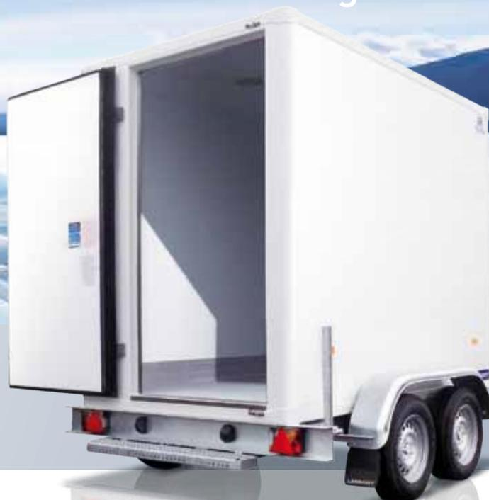
Offrendo un volume utile da 5 a 7 m<sup>3</sup>, è un vero e proprio veicolo personalizzabile a seconda della vostra attività e adatto al trasporto di derrate deperibili di grande volume. In versione "trasporto carne" con apertura posteriore totale, ganci, altezza utile aumentata e pavimento antiscivolo rosso, rappresenta la soluzione ideale per gli operatori del settore della carne.
