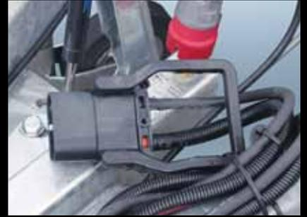
**Raccordo veicolo (modalità strada):** In modalità strada (optional), il gruppo elettrico è collegato per mezzo di una presa "fenwick" alla batteria del veicolo trainante, il cui alternatore deve disporre di un minimo di 90 A. In caso contrario un "kit potenza" montato in servizio post vendita è adattabile ad alcuni veicoli.
