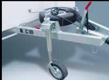
**Accessori telaio (di serie):** Tutti i rimorchi sono dotati di una serie completa di accessori: ruota jockey per semplificare le manovre; 2 barre stabilizzatrici sulla parte posteriore e freno di stazionamento per uso statico o parcheggio; ruota di soccorso e manovella; presa rimorchio a 13 poli con adattatore amovibile a 7 poli.
