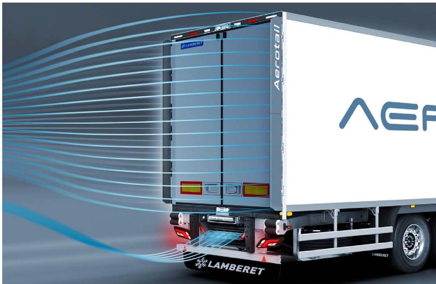
Gli Aerotail sono i primi spoiler posteriori a funzionare in modo completamente automatico. La diminuzione dei consumi rilevata è di almeno 1% in condizioni miste.
