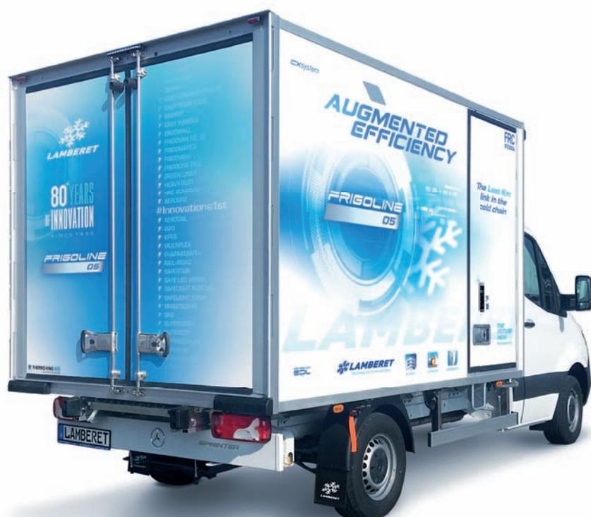
Il nuovo Sprinter telaio-cabina è già disponibile in versione frigorifera con le casse Frigoline Lamberet. Le carrozzerie Frigoline sono disponibili in versione pallet, Rolls, trasporto carne, gastronomia, multitemperatura...
