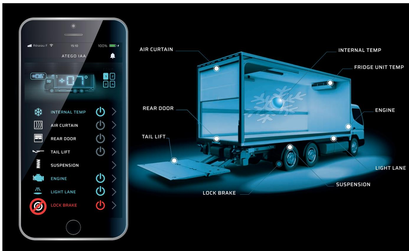
*La tecnologia del multiplexing implementata da Lamberet offre nuove funzionalità dedicate all'efficienza. L'applicazione MULTIPLEX è compatibile con tutti gli smartphone e con una connessione Bluetooth.*
