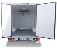
Questa carrozzeria è destinata al trasporto in temperatura controllata, conformemente alla regolamentazione ATP in vigore.
