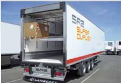
**Apertura rientrante** : La serranda isolante, con apertura manuale, o elettrica silenziosa (certificato PIEK 54 dB) facilita la distribuzione. Ultra-resistente, in acciaio inox, completamente bullonata, offre una protezione completa (soglia, montanti verticali alti e bassi).
