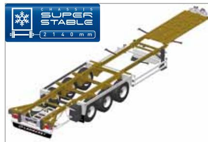
**Telaio SuperStable** : Inedito, combina il controllo del baricentro grazie ai longheroni ad H in acciaio THLE con un'altezza ridotta a 180 mm, e a un treno di ruote ampliato che riduce l'abbassamento in curva per ridurre significativamente la velocità critica del passaggio in curva.
