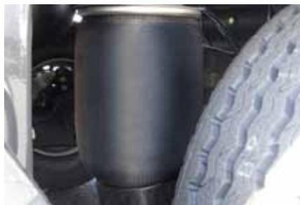
**Cuscini della sospensione pneumatica rinforzati di 360 mm** : Grazie ad una superficie di appoggio maggiore del 44%, il carico viene distribuito meglio, la sospensione si contorce meno e offre più resistenza, riducendo lo spostamento del baricentro. Un doppio circuito pneumatico alimenta indipendentemente ogni lato dalla sospensione per smorzare il rollio in curva.
