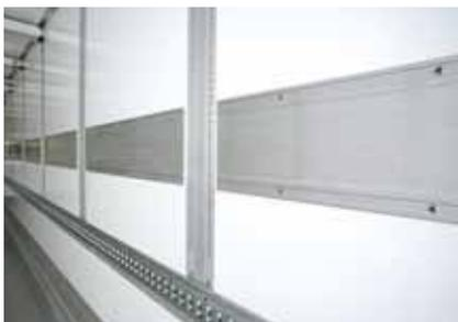
**Binari verticali Duplex al 100% incastrati** : Il sistema duplex è composto da 12 binari in alluminio ad alte prestazioni contro le abrasioni, disposti a 1.208 mm di interasse, senza supporto sui fianchi. La qualità dell'isolamento è «Rinforzata» senza compromettere la larghezza utile, né le manipolazioni del caricamento.
