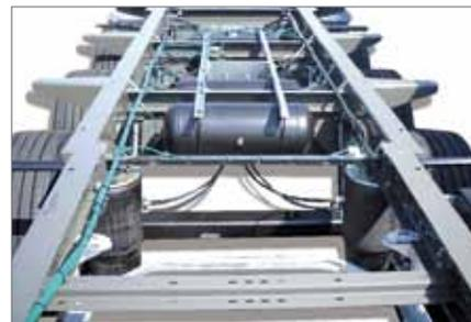
**Carreggiata dell'asse ampliata a 2140 mm** : Il treno di ruote ampliato è inedito. L'interasse dei longheroni del modulo centrale è aumentato da 100 mm a 1400 mm, e porta la carreggiata dell'asse a 2140 mm, ovvero lo standard di stabilità per le cisterne più esigenti. Il telaio «Super Stable» aumenta la soglia di ribaltamento del 15%: guadagno in funzione del regolamento CEE N° 111, allegato 4.
