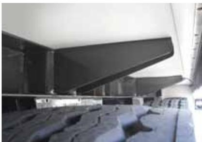
**Stabilizzatori laterali** : Il peso del carico duplex viene trasferito sui fianchi laterali. Queste forze vengono trasferite verso il centro del telaio tramite appoggi laterali integrati al telaio Super Stable. Il bilanciamento delle forze verticali migliora la portanza al suolo del carico, a vantaggio della stabilità.
