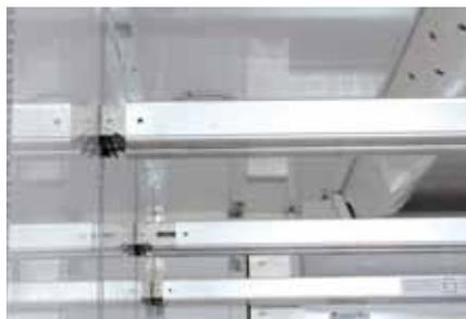
**22 travi duplex regolabili verticalmente con regolazioni di 25 mm e rimovibili** : Ogni trave è munita di una capacità di 1 tonnellata, in grado di modulare il carico delle 33 pallet da 800 x 1200 mm. I binari intermedi possono essere installati per le pallet da 800 x 600 mm.
