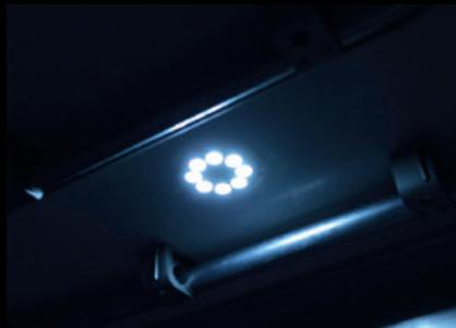
**Iluminación interior LED de alta luminosidad:** De manera opcional, existen 4 paneles LED encastrados con interruptor interior temporizado que aportan una iluminación excepcional, un bajo consumo eléctrico y una gran durabilidad. Los interruptores y cableados encastrados no corren el riesgo de engancharse con los dispositivos de manipulación de la carga.
