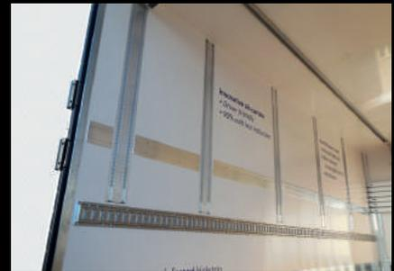
**Carga dúplex a doble altura:** Sistema con raíles verticales encastrados en las caras laterales y vigas transversales que pueden soportar hasta 1000 kg y que permiten una disposición de los palés a doble altura.
