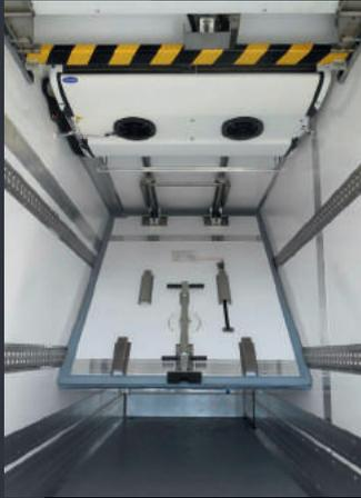
**Divisoria transversal móvil:** Resulta ergonómica, con su trampilla de descompresión, sus cilindros de gas o compases de resorte ajustados para cada altura interior, su junta
