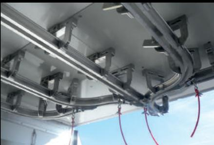
Las carrocerías Lamberet se pueden equipar con todas las configuraciones de ganchos para carne y accesorios especializados: tubos, raíles dobles, guías de corredera, desviadores, sistemas de manipulación de carne...
