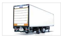
Modulo posteriore adatto ai portelloni retraibili standard: L'integrazione trasparente e ottimizzata del sistema di assi sterzanti X-Steering permette di offrire un modulo di telaio posteriore standard totalmente adatto all'installazione di un portellone retraibile dotato di una piattaforma pieghevole in due parti classica. X-City preserva così l'efficacia delle operazioni.
