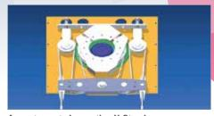
Asse sterzante innovativo X-Steering: Ultima generazione di assi sterzanti, il sistema X-Steering ritrascrive meccanicamente sull'asse sterzante la virata indotta dal trattore a livello del perno attraverso un sistema di torrette azionato da alcuni cavi. Questa architettura, sia a livello del
