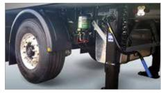
Easy-maintenance: Il sistema di assi sterzanti a cavi è molto competitivo in termini di manutenzione. Per garantire il buon funzionamento del sistema è sufficiente una visita annuale di verifica. L'ingrassaggio deve essere realizzato soltanto ogni 300.000 km, oppure attraverso un sistema di ingrassaggio centralizzato opzionale. Senza elettricità, né elettronica, è un investimento che offre un ritorno su investimento molto rapido.
