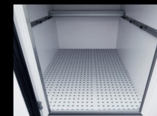
**Graticcio (optional):** Il pavimento è ricoperto di lastre in plastica amovibili e traforate, facili da lavare, al fine di fornire una ventilazione ottimizzata, impedire il contatto tra le derrate e il suolo e proteggere il carico dall'acqua formata dalla condensa. Raccomandato nel quadro di una pratica igiene "HACCP".
