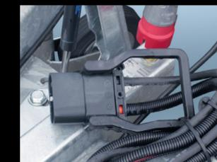
**Raccordo veicolo (modalità strada):** In modalità strada (optional), il gruppo elettrico è collegato per mezzo di una presa "fenwick" alla batteria del veicolo trainante, il cui alternatore deve disporre di un minimo di 90 A.
