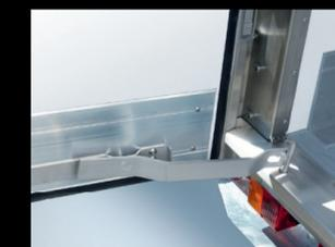
**Blocco porte:** I rimorchi Lamberet sono dotati di blocco porte (in caucciù o a T, a seconda del modello). Per semplificare le operazioni nelle zone di stazionamento strette, sono disponibili sul OT2 come optional dei blocchi a 100° (foto).
