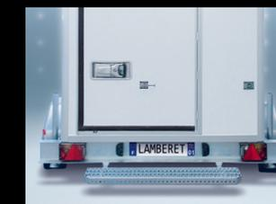
**Gradino:** Integrato nella versione 750 kg o collegato al telaio nelle versioni 1300 e 2000 kg, il gradino in acciaio fisso "1 livello" anticivolo facilita l'accesso alla zona di carico.
