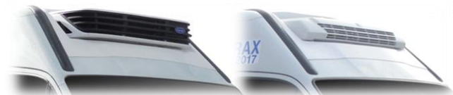
Groupe splités avec encastrément aérodynamique
