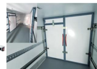
Sicherheitsvorschriften haben zu einer kontinuierlichen Gewichtszunahme bei Fahrgestellen geführt, wodurch die Nutzlast insbesondere bei Mehrkammer-Kühlsystemen reduziert wurde. Lamberet begegnet dieser Herausforderung mit der neuen ERGOWALL VUL-Trennwand. Seitlich klappbar, ergonomischer und praktischer – sie reduziert das Gewicht um 60 kg im Vergleich zu deckenmontierten Trennwänden.
