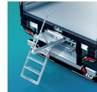
Die einziehbare Safestair-Trittstufe sorgt für eine sichere Ein- und Ausstiegsmöglichkeit bei Kühl-LKWs und -Aufliegern. Die automatische Rampe bietet einen dritten Stützpunkt und verringert das Sturzrisiko.
