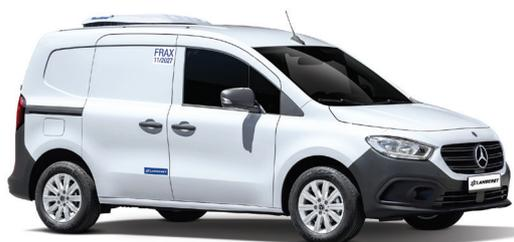
Völlig neu ist der Citan die ideale Basis für einen Kühlkastenwagen, der in der Lage ist, unter besten Bedingungen fast 2m<sup>3</sup> transportieren kann. Die Kühlzelle bietet von Anfang an eine seitliche Schiebetür, während sie über eine verstärkte ATP-Zulassung in isothermer Qualität verfügt, um die Kühlkette aufrecht zu erhalten und den Energieverbrauch zu optimieren. Erhältlich in den Längen L1 und L2. ■
