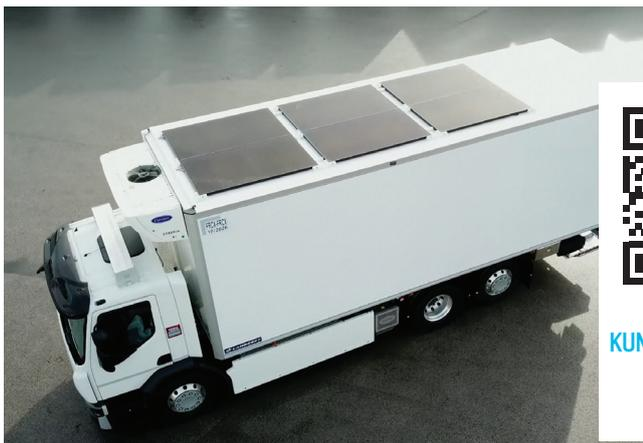
Lamberet hat das Dach der Aufbauten mit 6 Solarmodulen ausgestattet, was einer Fläche von 10 m<sup>2</sup> bei einer Spitzenleistung von 2400 W entspricht.
