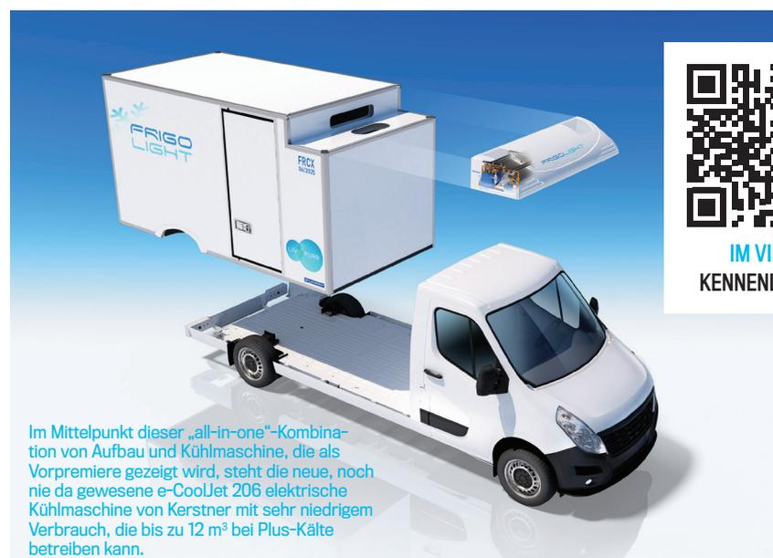
Im Mittelpunkt dieser „all-in-one“-Kombination von Aufbau und Kühlmaschine, die als Vorpremiere gezeigt wird, steht die neue, noch nie da gewesene e-CoolJet 206 elektrische Kühlmaschine von Kerstner mit sehr niedrigem Verbrauch, die bis zu 12 m³ bei Plus-Kälte betreiben kann.
