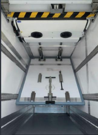
**Mobile Querwand:** Diese ist ergonomisch mit Dekompressionsöffnung, Gaswinden oder Stellfedern für jede Innenhöhe, integraler synthetischer Dichtung mit Reduzierung von Reibung und Resistenz gegen Verhärtung bei Kälte. Die integrierten Profile schützen gegen Schläge und optimieren den Luftstrom der einzelnen Kammern.
