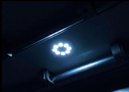
**LED-Innenbeleuchtung mit hoher Leuchtkraft:** Optional: 4 eingelassene LED-Deckenleuchten mit innen angebrachtem Zeitschalter sorgen für ausgezeichnete Beleuchtung, niedrigen Stromverbrauch und Haltbarkeit ohne Schwachstellen. Die eingelassenen Schalter und Kabel sind gegen Beschädigung durch Handling-Maschinen geschützt.
