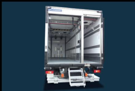
Nach Maß gefertigt: Dank seines Know-how kann Lamberet eine automatische impuls-gesteuerte Tür Distri+ und eine Flügeltür in derselben Karosserie verbauen.
