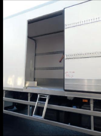
**Seitlicher Zugang über Flügel- oder Schiebetür:** Im Hinblick auf einfachen Zugang unter sämtlichen Bedingungen im Ladebereich haben Sie die Wahl zwischen einfachen oder doppelten Flügel- und Schiebetüren.
