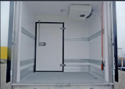
**Feste Querwand:** Je nach Bedarf des Kunden kann der Kasten mit fester Querwand mit Tür in der vorderen Kammer ausgerüstet werden.
