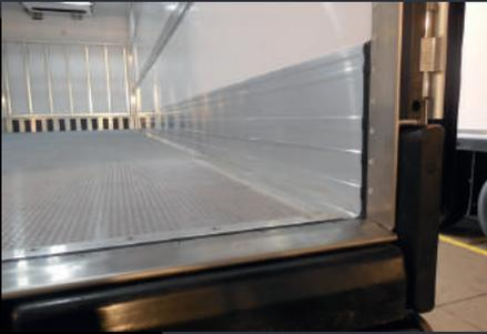
**HD-Sockelleisten:** Außergewöhnliche Sockelleisten für außerordentliche Anforderungen: 5 Rippen von 7 mm, bündig verklebt und im Boden verschraubt, auf ganzer Länge der Seitenflächen in 300 mm Höhe geklebt und genietet, zusätzliche Verschraubung am Rahmeneingang.
