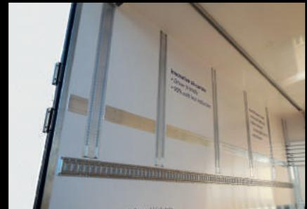
**Ladung auf zwei Ebenen:** System mit in den Seitenflächen eingelassenen vertikalen Schienen und Querträgern; ausgelegt für 1000 kg und Palettierung auf 2 Ebenen.
