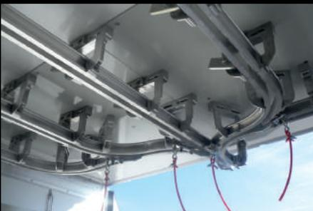
Lamberets Karosserien sind für alle erdenklichen Konfigurationen von Hängevorrichtungen für Fleisch und Spezialzubehör geeignet: Rohre, Bi-Schienen, Laufschiene, Weichen, Fleisch-Handhabungssystem...
