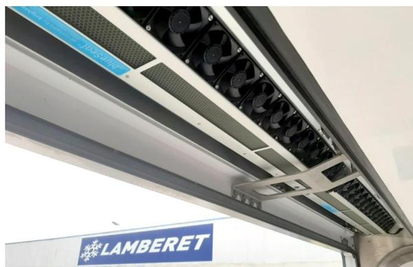
Eindringen von Feuchtigkeit, selbst bei häufigem Öffnen und Schließen des automatischen Rolltors. Dank der kompakten Bauform des Rolltors lässt sich der Luftvorhang vollständig integrieren, ohne die Durchladehöhe zu reduzieren. Das Gerät ist damit auch vollständig vor Beschädigungen beim Be- oder Entladen geschützt.
