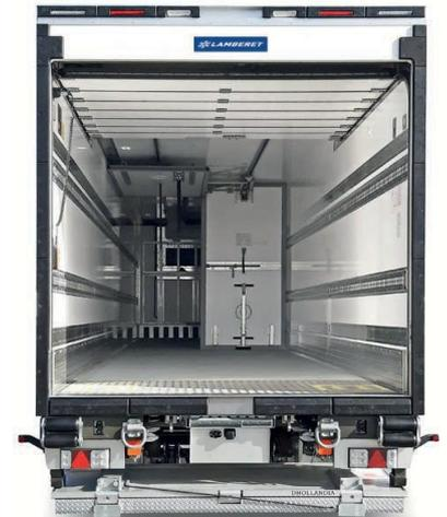
Auch den Hebemechanismus haben die Lamberet-Entwickler optimiert. So verfügt das DISTRI+ über eine geteilte Federunterstützung – je eine Welle für die linke und rechte Seite. Diese Konstruktion ermöglicht eine optimale Justierung des Antriebs pro Seite und gewährleistet damit minimalen Verschleiß und lange Lebensdauer. Zudem lässt sich das Tor im Schadensfall auch mit nur einer Feder betätigen. Ein Totalausfall ist somit ausgeschlossen.
