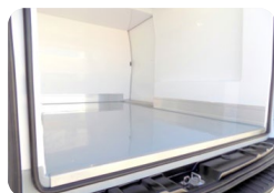
Zur Aufnahme von Paletten ausgelegter Ladeboden und Radkastenschutz
