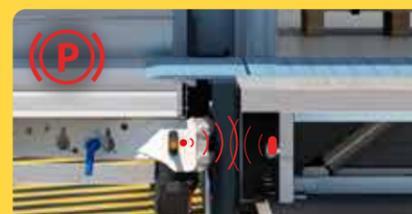
3. Laderampe im Einsatz, RFID-TAG sichtbar, Bremsen blockiert
