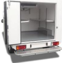
Cette carrosserie est destinée au transport sous température dirigée, en conformité avec la réglementation ATP en vigueur.
