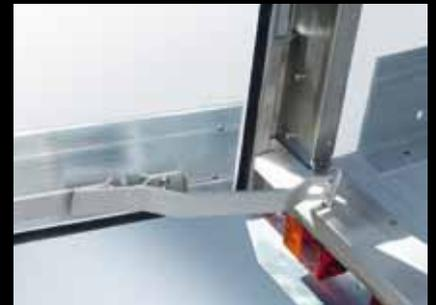
**Türfeststeller:** Die Lamberet-Anhänger sind mit Türarretierung ausgestattet (Kautschuk oder T, je nach Modell). Um Arbeiten in engen Haltezonen zu ermöglichen, ist optional eine Arretierung bei 180° verfügbar (Photo).
