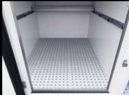
**Bodenrost (Option):** Der Boden ist mit abnehmbaren und durchbrochenen Kunststoffplatten ausgelegt, die leicht abzuwaschen sind, von einer optimierten Lüftung profitieren, den Kontakt zwischen Lebensmitteln und Boden verhindern und die Ladung vor Kondenswasser schützen. Empfohlen im Rahmen eines «HACCP»-Hygienekonzepts.
