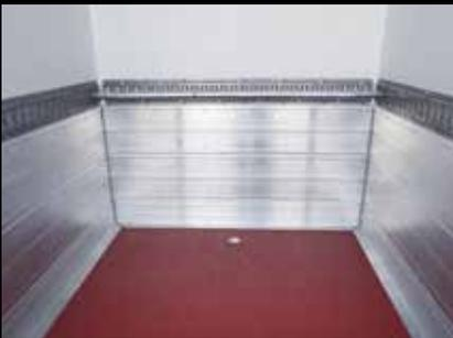
**Halteschienen und Leisten (optional):** Die Aluminium-Leisten schützen die Wände gegen Stöße. Die Halteschienen sichern und stabilisieren Ihre Ware während des Transports.
