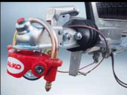
**Diebstahlsicherung (Option):** Die an der Kupplungsdeichsel angebrachte Diebstahlsicherung sorgt für zusätzliche Sicherheit, indem sie das Ziehen Ihres Anhängers unterbindet. Deckenleuchte (nicht abgebildet): Wenn die Karosserie über ein Kühlaggregat verfügt, beleuchtet eine Deckenleuchte den Ladebereich.
