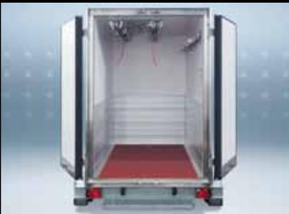
**Hängevorrichtungen für Fleisch (Option):** In der Version Fleischtransport verfügen die Anhänger ab 750 kg über Einsätze im Dach für die Befestigung eines an Ihre Geschäftstätigkeit angepassten Systems: Feste oder abnehmbare Schienen, Rohr oder kombiniert. Ergänzend kann der Boden mit rutschfestem, grobkörnigem, rot lackiertem Material versehen werden.
