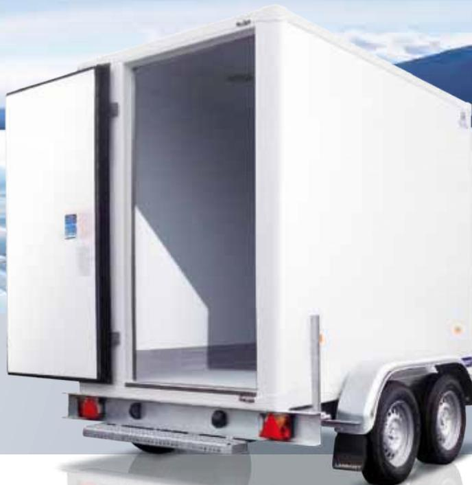
Der für im Nahrungsmittelgewerbe und Event Management Tätige\* entwickelte 1300-kg-Anhänger vereint ein hohes Nutzvolumen von fast 5 m<sup>3</sup> mit den Möglichkeiten der Anpassung an jede denkbare Geschäftstätigkeit: Palettierbare Version mit Hecköffnung "OT", Hängevorrichtungen für Fleisch, spezielle "Gastro"-Regale...
