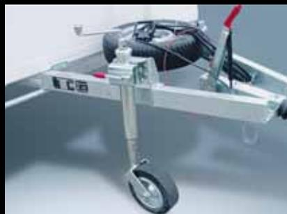
**Aufbauten (serienmäßig):** Sämtliche Anhänger verfügen über einen kompletten Aufbau: Stützrad für das Manövrieren; 2 Stabilisatoren am Heck und Feststellbremse für stationäre Arbeiten oder Parken; Ersatzrad und Kurbel; Steckdose Anhänger (13 Pins) mit abnehmbarem Adapter (7 Pins).
