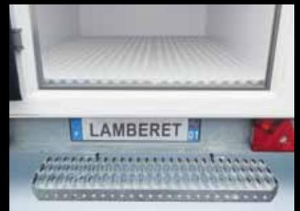
**Trittbrett:** Integriert bei der Version 750 kg oder am Chassis montiert bei der Version 1300 und 2000 kg; das rutschfeste Trittbrett aus Stahl («1 feste Höhe») bietet Zugang zum Ladebereich.
