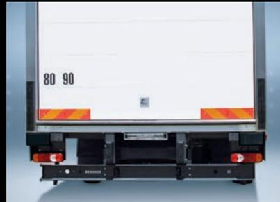
**Apertura a Sollevamento (OR) :** il telaio serranda isolante ad apertura manuale accelera le manovre, senza ingombro esterno in posizione aperta. Interamente montato con bulloni, è super resistente.
