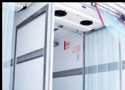
**Paratie :** Permettono di creare diversi compartimenti e di trasportare contemporaneamente carichi freschi e surgelati. Possono essere fissate longitudinalmente o trasversalmente con o senza porta, o trasversali e scorrevoli con sollevamento assistito tramite molla a gas.
