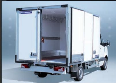
**Apertura totale posteriore 2 (OT2) o 3 (OT3) porte :** approfittate di un passaggio integrale per facilitare il carico dei pallet.
