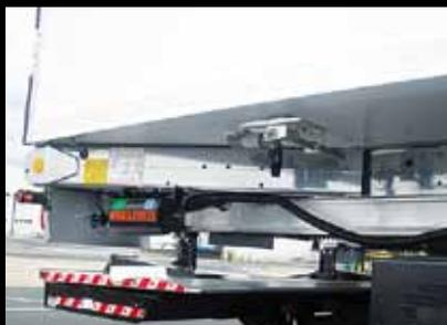
**Trattamento del telaio con sabbatura e verniciatura a polvere, garanzia anti-corrosione di 6 anni.**
