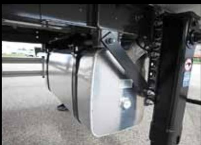
**Serbatoio in alluminio di grande capacità:**
