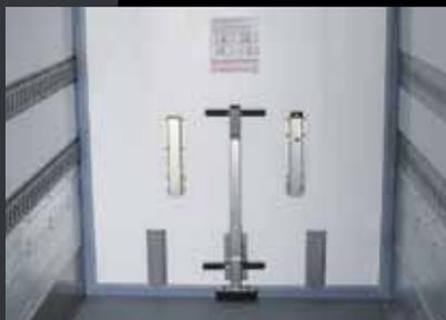
**Paratia mobile** : ergonomica, dotata di una guarnizione sintetica che riduce gli sfregamenti e che non si indurisce con il freddo. Profili che proteggono dagli urti e ottimizzano i flussi d'aria in ogni scomparto.
