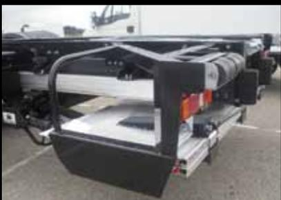
**Trattamento del controtelaio con sabbatura e verniciatura a polvere**, garanzia per 6 anni anti corrosione.
