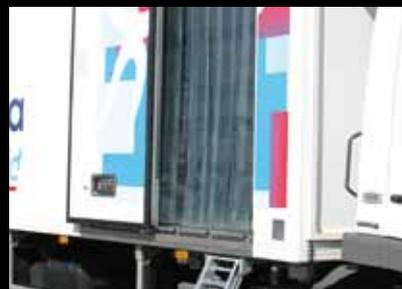
**Porta laterale scorrevole** : grazie ad un sistema brevettato, la porta scorrevole si integra completamente nella carrozzeria senza interferire con il fondo del telaio.
