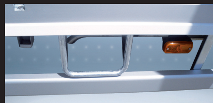
Etrier Fixe En U, simple ou double pour accès latéral ou arrière rapide
