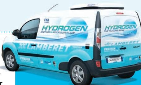
Frigovan H<sub>2</sub> Zéro Emission bénéficie d'une autonomie renforcée jusqu'à 400 km et d'un temps de recharge H<sub>2</sub> réduit avec un plein en moins de 5 minutes ! La chaîne du froid affiche une qualité supérieure : autonomie frigorifique de 8 heures, maintien de la réfrigération à l'arrêt et insensibilité à l'ouverture des portes.
