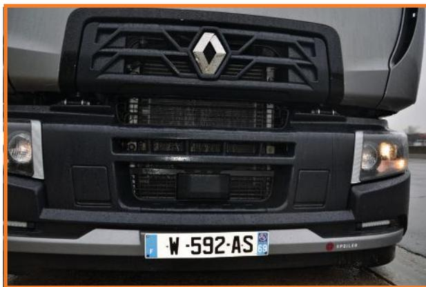
**Pour réduire les turbulences d'air, les roues ont été carénées et un bas-volet ajouté sous la calandre (ainsi que sur la liaison cabine-caisse). La portière côté conducteur devrait être rallongée et occulter les marches.**
