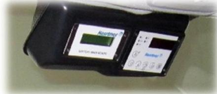
Indicateur de charge batterie et commande de groupe
