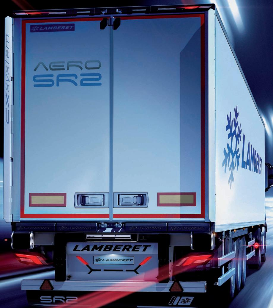
Lamberet a profité de l'application du nouveau règlement R58-03 renforçant la sécurité des usagers de la route face au risque d'encastrement arrière, pour revoir le design des châssis SR2.
