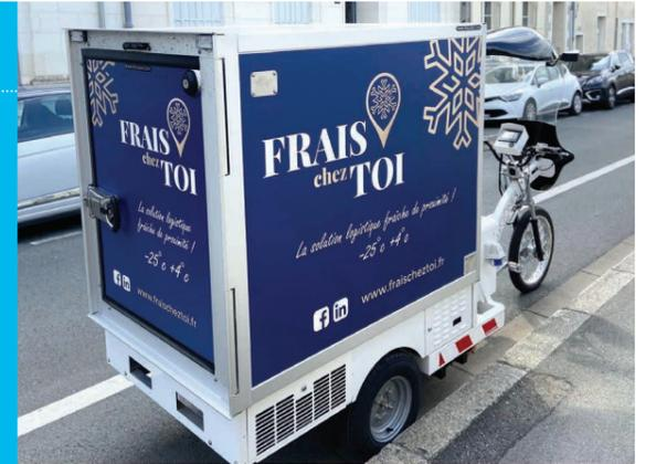
KLEUSTER Freegone s'équipe de la nouvelle cellule Frigoline coefficient K 0.31 et d'un groupe frigorifique en froid positif, plug & play.
