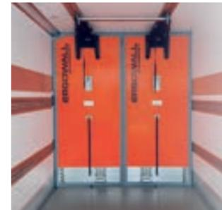
Ergowall 2.0 révolutionne l'optimisation du transport multi-compartiments avec des améliorations majeures. Toujours dotée d'une mousse à mémoire de forme isolante et d'un revêtement en polycarbonate ultra-résistant teinté orange, elle intègre un chariot de relevage multi-force plus compact et une fonction exclusive d'accostage optimisé au chargement.
