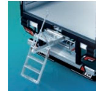
Le marche-pied escamotable Safestair sécurise la montée et la descente des porteurs et semi-remorques frigorifiques. Sa rampe automatique offre un troisième point d'appui, réduisant les risques de chute. Conforme aux normes VASP camping-car, il garantit une sécurité optimale pour les utilisateurs.
