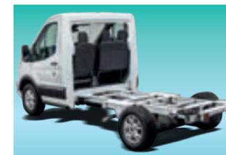
Plébiscitée pour la distribution urbaine et les traiteurs, l'offre de plancher-cabine 3,5 t s'élargit avec le lancement de la carrosserie Frigoline sur Ford Transit châssis modulaire. Cette solution offre un plancher bas et une charge utile supérieure aux châssis-cabines classiques.
