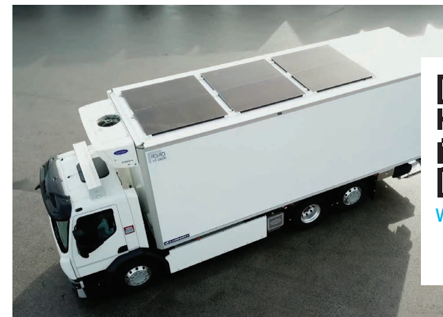
Lamberet a équipé le toit de la carrosserie de 6 panneaux solaires, soit une surface de 10 m 2 pour une puissance de 2 400 W en crête.
