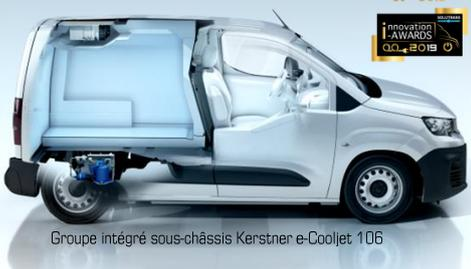
Groupe intégré sous-châssis Kerstner e-Cooljet 106
