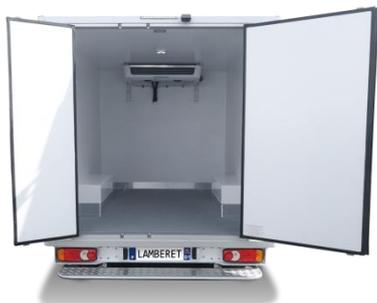
Cette carrosserie est destinée au transport sous température dirigée, en conformité avec la réglementation ATP en vigueur.
