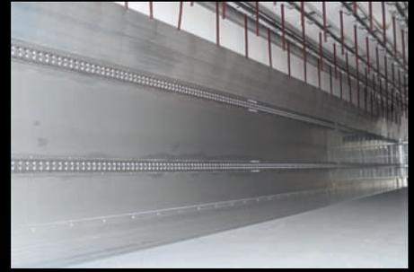
**Interinox, partiel ou intégral** : en option, les faces latérales intérieures peuvent être revêtues de l'Interinox partiel ou intégral. Véritable doublage de la paroi intérieure, la tôle inox protège des chocs haut de rolls utilisés en distribution ou des agressions des carcasses en configuration porte-viande.
