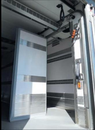
**Cloison fixe longitudinale** : elles permettent généralement de séparer les denrées surgelées et le frais en livraison urbaine (par l'arrière ou le côté avec des portes latérales et dans la cloison).
