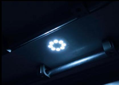
**Eclairage intérieur LED haute luminosité** : En option, 4 plafonniers LEDS encastrés avec interrupteur intérieur temporisé apportent un éclairage exceptionnel, une faible consommation électrique et une durabilité sans faille. Les interrupteurs et câblages encastrés ne peuvent être accrochés par les engins de manutention.
