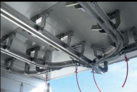
Les carrosseries Lamberet peuvent être équipées de toutes les configurations de penderies à viande et accessoires spécialisés : tubes, bi-rails, glissière italienne, aiguillages, manuviance...
