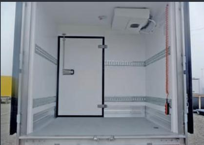
**Cloison transversale fixe** : Suivant le besoin du client, la caisse peut être équipée d'une cloison transversale fixe avec une porte d'accès au compartiment avant.
