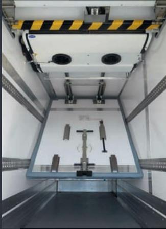
**Cloison transversale mobile** : Elle est ergonomique avec sa trappe de décompression, ses vérins à gaz ou compas à ressorts ajustés pour chaque
