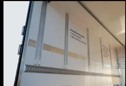
**Chargement double-étage duplex** : Système avec rails verticaux encastrés dans les faces latérales et poutres transversales pouvant supporter 1 000 kg permettant une palettisation sur 2 niveaux.
