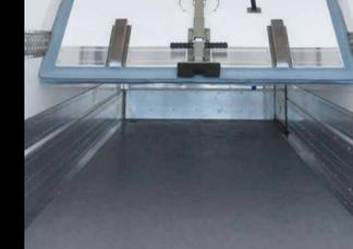
**Cloison transversale mobile sur 2 glissières** : Facile à utiliser grâce à sa trappe de décompression et assistée à l'ouverture/fermeture par compas à gaz. Jointement étanche par multilèvres silicone compatible température négative.
