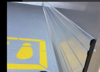
**Plinthe spécifique aluminium** d'un seul tenant collée et renforcée par 6 nervures de 5 mm avec retour encastré, collé et vissé dans le plancher. Hauteur de 300mm, fixation renforcée en entrée de cadre avec joints de rupture de pont thermique.
