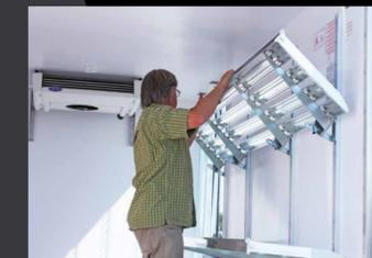
**Aménagement traiteur** : les étagères réglables en hauteur et relevables, disponibles en plusieurs niveaux et plusieurs profondeurs (400, 500, 600 mm), permettent de transporter vos denrées de manière protégées, ordonnées et flexibles.
