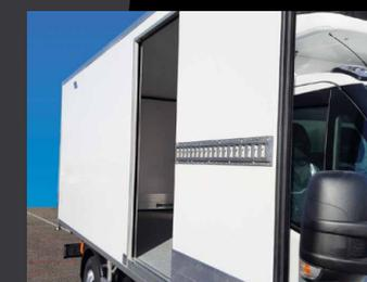
**Porte latérale simple battante ou coulissante** : elles s'adaptent à votre logistique grâce à 2 largeurs et hauteurs des positions multiples. L'étanchéité est assurée par un jointement périphérique multilèvres.
