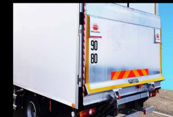
**Hayon élévateur** : L'arrière du châssis peut être équipé de différentes configurations de hayon pour faciliter vos manoeuvres : hayon rabattable ou demi-hayon, disponibles en plusieurs charges et dimensions.
