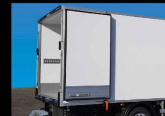
**Ouverture Totale arrière 2 (OT2) ou 3 (OT3) vantaux** : bénéficiez d'un passage intégral pour faciliter les chargements de palettes. Avec 3 vantaux (OT3), le battant central, pendu à gauche ou à droite, facilite également la distribution.
