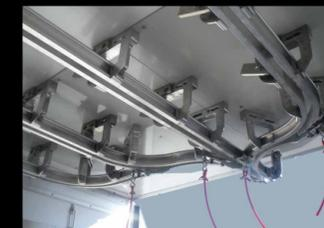
Les carrosseries Lamberet peuvent être équipées de toutes les configurations de penderies à viande et accessoires spécialisés : tubes, bi-rails, glissière italienne, aiguillages, manuvie...
