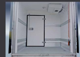
**Cloison transversale fixe** : Suivant le besoin, la caisse peut être équipée d'une cloison transversale fixe avec une porte d'accès au compartiment avant.
