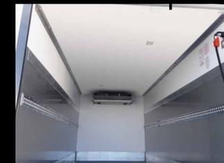
**Doublage Interinox partiel** : agit comme un blindage et se superpose au parement polyester. L'inox ralentit l'usure par abrasion et renforce les faces latérales sujettes aux déchirures et poinçonnements des os des quartiers de viande.
