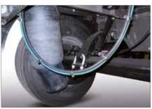
Coussins de suspension dédoublés : les 6 coussins de suspensions dédoublés sont totalement adaptés pour le transbordement sur les plateformes de wagons et quais, sans limitation de course.
