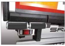
Système de protection intégral : le design Lamberet exclusif rend le respect du gabarit ferroviaire compatible avec une protection renforcée de l'arrière du châssis, équipé de double butoirs horizontaux à rouleaux amortisseurs. Les montants verticaux et le seuil sont totalement protégés par des butoirs intégrés.
