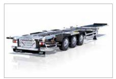
Voie d'essieu adaptée à 2040 mm : prédisposition complète aux restrictions dimensionnelles du wagon, la voie d'essieu du châssis est ramenée à 2040 mm. La meilleure rigidité du chassis boulonné SR2 permet de maintenir une faible hauteur de longeron, au bénéfice de l'abaissment du centre de gravité, offrant la meilleure tenue de route du marché.
