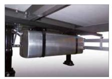
Autonomie maximale : réservoir aluminium grande capacité de 420 litres. Résistant au vieillissement et à la corrosion, sa capacité exceptionnelle s'associe à la performance de l'isolation composite Lamberet pour offrir un surcroît d'autonomie. Un véritable avantage pour le transport ferroviaire longue-distance.
