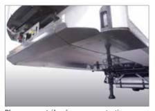
Plaques avant élargies : une protection maximale pour les usages sévérisés par des tiers lors d'opérations de transbordement répétées. La face avant est ainsi préservée des impacts sur toute sa largeur.
