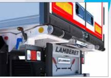
Module arrière redimensionné : avec un retrait de 300 mm des équipements du module arrière, la mise en place de SR2 Rail-Road sur son wagon est facilitée, sans risque de dommages.
