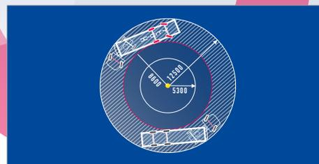
**Maniabilité à l'optimum de la courbe d'Ackermann :** Le système d'essieu directeur du châssis X-City offre une maniabilité avantageuse en zones difficiles d'accès. La giration des essieux, en tandem ou tridem, s'inscrit à l'optimum de la courbe d'Ackermann, qui régit les angles que doivent suivre les essieux d'une remorque par rapport à l'angle du tracteur.
