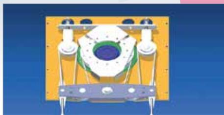
**Essieu directeur innovant X-Steering :** Dernière génération d'essieu directeur, le système X-Steering retranscrit mécaniquement sur l'essieu directeur la giration induite par le tracteur au niveau du pivot, à travers un système de tourelle actionnée par des câbles. Cette architecture, tant au niveau du pivot, de la tourelle et de leur liaison à câbles, est intégrée en toute transparence dans le châssis.
