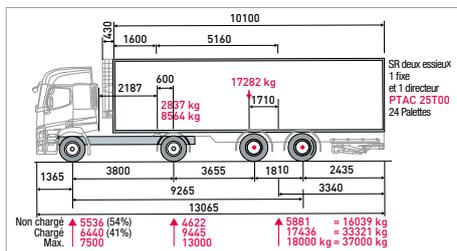
**Répartition des charges idéale :** X-City dans ses configurations tandem et tridem offre une répartition des charges idéale, à tout moment de votre tournée. Aucun risque de surcharge sur le pivot ou de délestage, une charge utile exploitable améliorée, une facilité d'entretien et un niveau de sécurité incomparables par rapport à une configuration 1 essieu roues jumelées : la version X-City tandem fait la différence.
