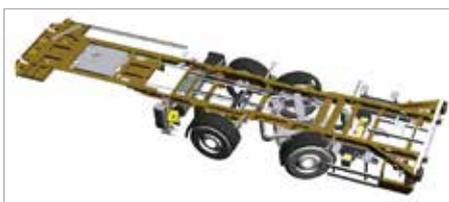
**La hauteur qu'il faut, là ou il faut :** Le mécanisme directeur X-Steering, tourelles et câbles, est totalement intégré de manière transparente au châssis. Les hauteurs de sellette d'attelage, de longerons de châssis (180 mm) et de seuil de chargement sont inchangées. X-City est ainsi compatible avec tous les quais de chargement standard, et son ratio hauteur-hors tout / hauteur de chargement demeure très performant.
