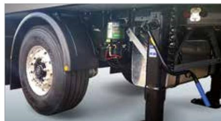
**Easy-maintenance :** Le système d'essieu directeur à câbles est hyper-compétitif en termes de maintenance. Une visite annuelle de vérification suffit à garantir le bon fonctionnement du système. Le graissage est réalisé à travers un système de graissage centralisé. Sans électricité ni électronique, c'est un investissement offrant un retour sur investissement très rapide.
