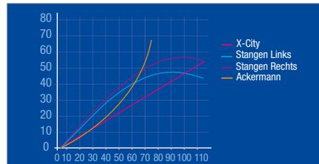
**Efforts de traction réduits : moins de consommation, moins de CO<sub>2</sub> :** La réduction du ripage et l'inscription de X-City dans une courbe de giration optimale par rapport au tracteur réduit significativement les efforts de traction nécessaires lors des virages : jusqu'à -66%. Il en résulte jusqu'à 12% de réduction de consommation dans le cadre d'une utilisation urbaine. Second bénéfice, la puissance du tracteur peut être réduite.
